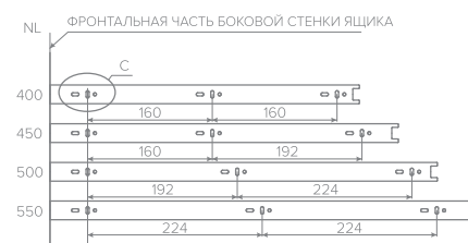
СХЕМА КРЕПЛЕНИЯ НА ВЫДВИЖНОЙ ЯЩИК
