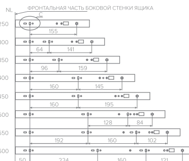
СХЕМА КРЕПЛЕНИЯ НА ВЫДВИЖНОЙ ЯЩИК
