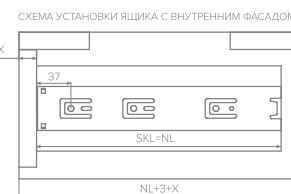
СХЕМА КРЕПЛЕНИЯ НА ВЫДВИЖНОЙ ЯЩИК
